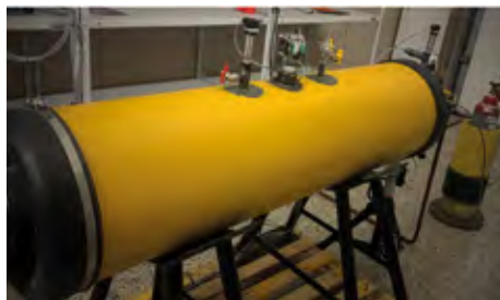
Rys. 6. Widok stanowiska badawczego II generacji. Odcinek testowy znajduje się wewnątrz komory i jest niewidoczny z zewnątrz
