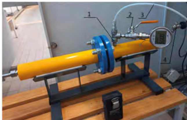
Rys. 2. Widok stanowiska I generacji po modyfikacji. 1 – wylot z komory, w której gromadzi się wodór po przeniknięciu przez próbkę, 2 – zawór wraz z manometrem, 3 – wężyk prowadzący do osuszacza kondensacyjnego i pompy, 4 – wlot powietrza wraz z zaworem dławicowym
