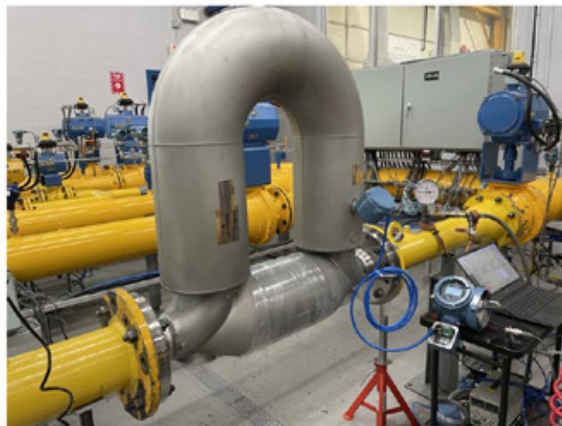
Coriolis CMF300 i CMF400 wyniki testów dla CO 2 99% - 16 bar 23° C
