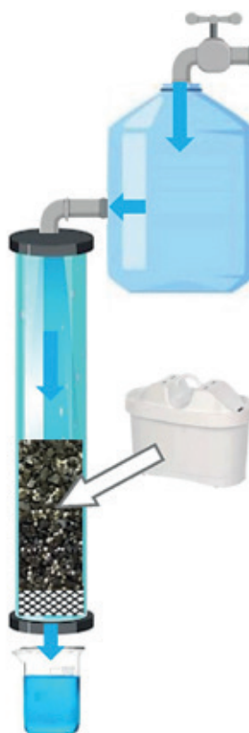
Rys.1. Schemat układu filtracyjnego wody wodociągowej zastosowanego w badaniach
