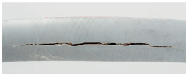
Rys. 1. Przykład działania kruchości wodorowej na metal [15]
