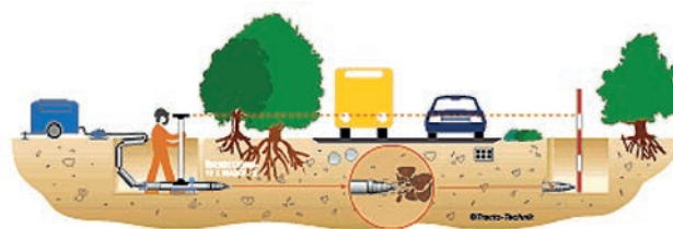
Rys. 1. Schemat metody GRUNDOMAT
