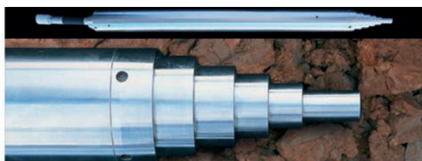
Rys. 7. Widok „kreta” polskiej produkcji oraz jego głowicy Fig. 7. View of the Polish-made „mole” and its head
