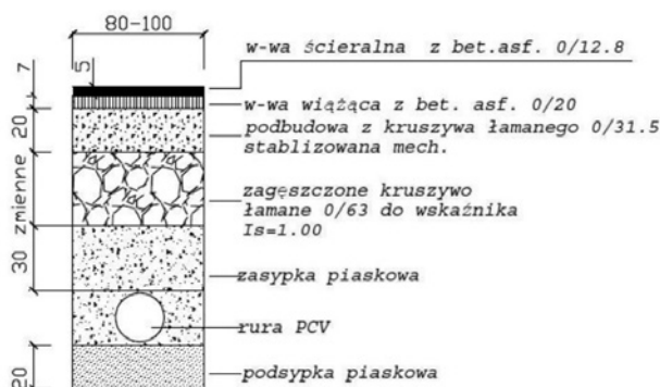
Rys. 5. Rura kanalizacyjna ułożona pod jezdnią. [1]
