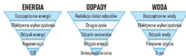
Rys. 1. Hierarchia postępowania z energią, wodą i odpadami zgodnie z ideą Net-Zero [4] Fig. 1. Net-Zero energy, water and waste hierarchies [4]
