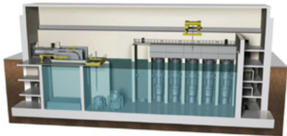
Rys. 6. Model elektrowni jądrowej złożonej z 6 modułów SMR według firmy NuScale [10] Fig. 6. Concept of 6 modular nuclear energy plant type developed by NuScale Power
