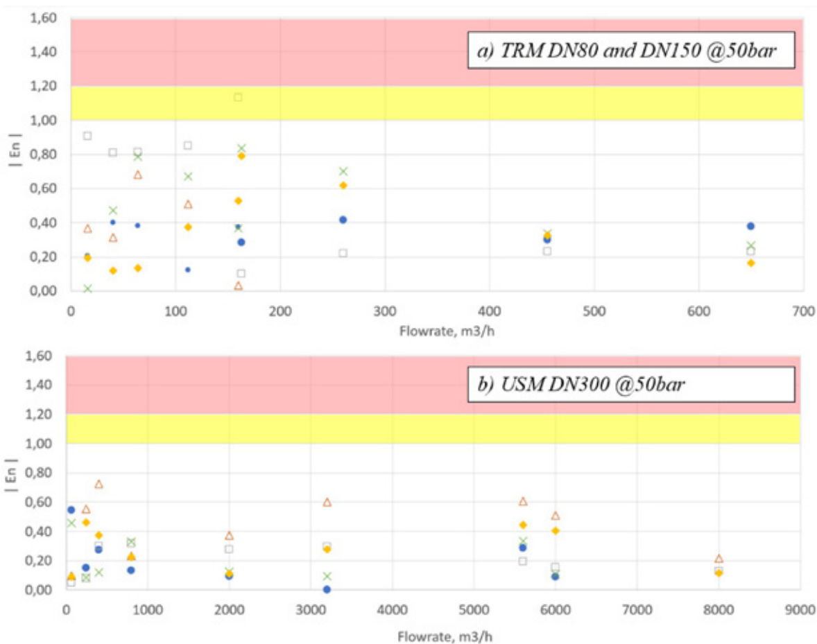
Fig. 8 ILC type B results – degree of equivalence E_n @50 bar Rys.8 Wyniki ILC typu B – stopień równoważności E_n przy 50 barach
