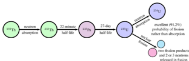
Rys. 9. Cykl powstawania z toru rozszczepialnego uranu U-233 [13]
