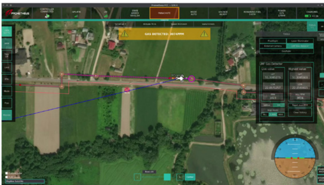
Rys. 4. Screen panelu sterowania platformą Prometheus H2 – przedstawiający wykrycie emisji metanu w czasie rzeczywistym (źródło: Prometheus SA)
