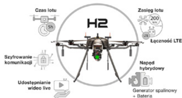
Rys. 2. Nowoczesne rozwiązania technologiczne zastosowane w Hybrydowej Platformie Dronowej – Prometheus H2 (źródło: Prometheus SA) Fig.2. Modern technological solutions used in the Hybrid Drone Platform - Prometheus H2 (source: Prometheus SA)
