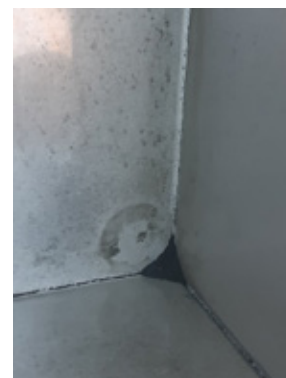
Rys. 6. Pył zbierany przez multicyklon Fig. 6. Dust collected by multicyclone
