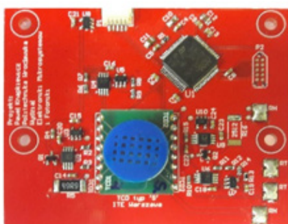
Rys.2. Moduł kalorymetryczny dostosowany do zabudowania w gazomierzach
