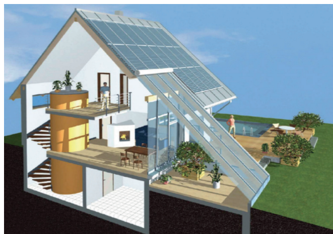
Rys. 2 Zasobnik ITES w aranżacji domu jednorodzinnego [11]
