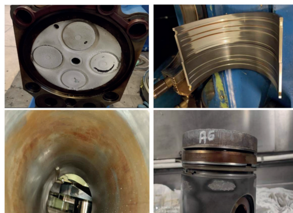
Rys. 7 Nagar i uszkodzenia spowodowane obecnością siloksanów w biogazie Fig. 7 Carbon build-up and damage caused by the presence of siloxanes in biogas.
