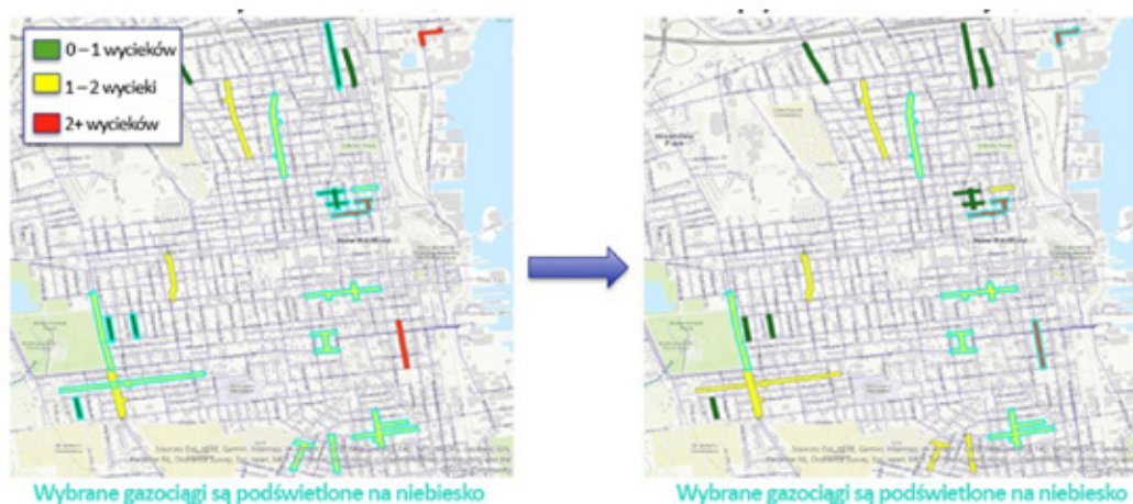
Rys. 6. Optymalizacja istniejących projektów PPSG na lata 2020-2021 dla 16 km do wymiany. Projekty o największej gęstości wycieków są wybierane na 2020 r., aby zmaksymalizować liczbę wycieków usuniętych w 2020 r.
