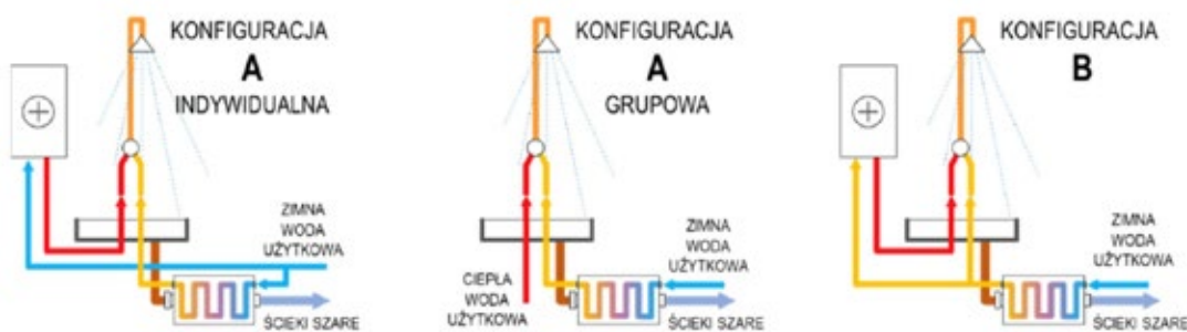
Rys. 2. Konfiguracje podłączenia wymiennika ciepła do instalacji prysznicowej
