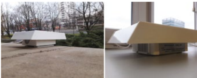
Rys. 1. Urządzenia pomiarowe MAQS (węzły sieci czujnikowej)
