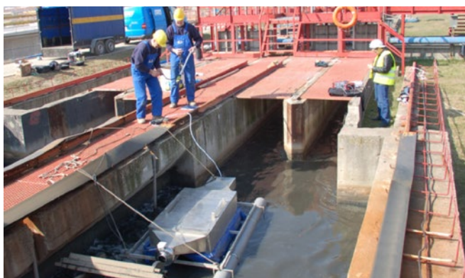
Rys. 7. Osłona typu wind tunnel (z wymuszonym przepływem powietrza) do pobierania próbek powietrza z piaskownika Fig. 7. Wind tunnel type cover (with forced air flow) for taking air samples from the sand trap
