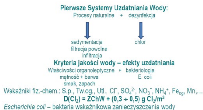
Rys. 6. Koncepty technologiczne zakładów uzdatniania wód powierzchniowych stosowane na przełomie XIX i XX wieku
