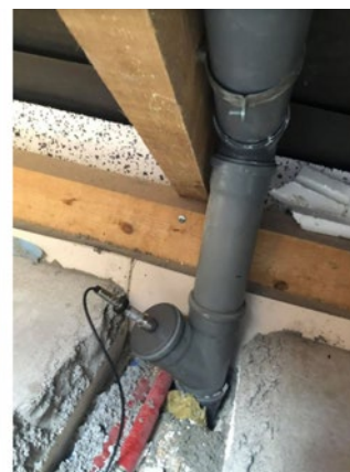
Rys. 4. Umiejscowienie przetwornika ciśnienia w układzie Fig. 4. Location of the pressure transducer in the system
