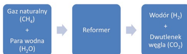
Rys.2. Reforming gazu naturalnego, [36]
