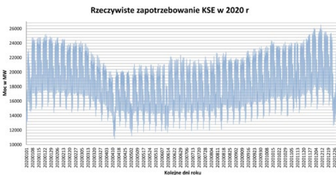
Rys.4. Rzeczywiste zapotrzebowanie KSE w 2020 r. Opracowanie własne na podstawie [21]
