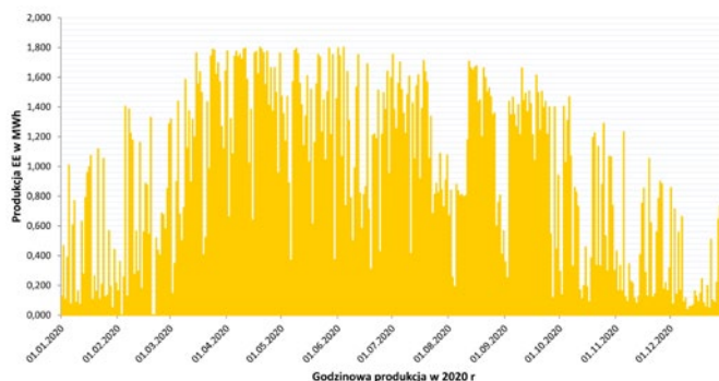
Rys. 20. Roczny przebieg zmienności produkcji wybranej elektrowni fotowoltaicznej. Opracowanie własne.
