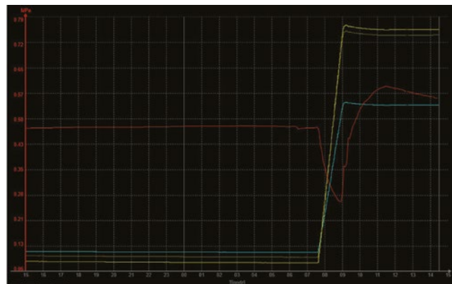
Rys. 4. Zmiany ciśnienia w zbiorniku podczas napełnienia LNG (źródło: PSG, pomiary z telemetrii)
