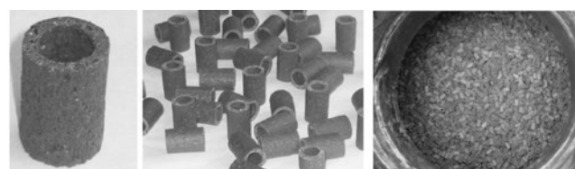
Rys. 2. Elementy WMO (a – pojedyncza kształtka z widoczną strukturą porowatą, b – elementy wypełnienia po procesie wytłaczania, c – WMO w reaktorze beztlenowym) Fig. 2. WMO elements (a – a single piece with a visible porous structure, b – filling elements after the extrusion process, c – WMO in an anaerobic reactor)
