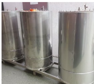
Rys. 3. Kolumny filtracyjne w instalacji technologii PTSA
