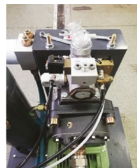
Rys. 4. Sprężarka łopatkowa do wstępnego sprężania gazu do instalacji oczyszczania
