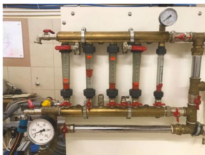
Rys. 2. Zestaw rotametrów wykorzystany w badaniach Fig.2. Set of rotameters applied to the study
