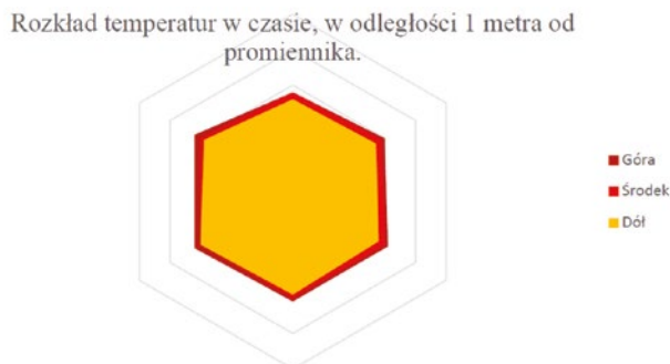
Rys. 8. Rozkład temperatur wyznaczony na różnych wysokościach dla promiennika tarasowego z otwartym ogniem typu WATRA
