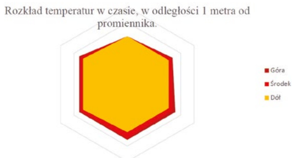
Rys. 6. Rozkład temperatur wyznaczony na różnych wysokościach dla promiennika tarasowego z ogrzewaniem rurowym typu ETNA
