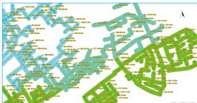
Rys. 9. Wizualizacja zasięgu źródeł poprzez określenie udziału źródeł w zasilaniu sieci Fig. 9. Visualization of gas distribution by identification of sources share in total grid supply
