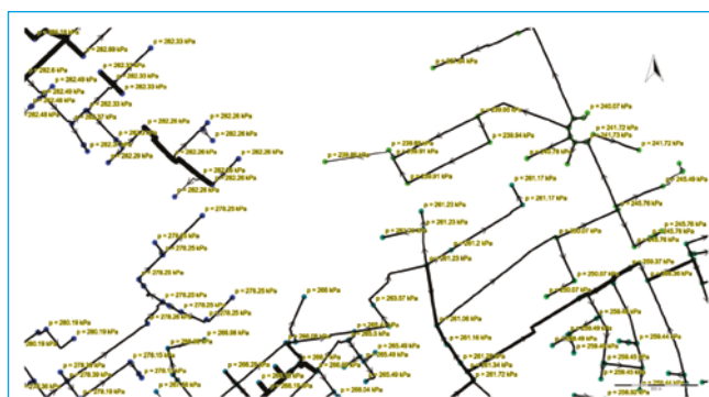
Rys. 8. Prezentacja wyników symulacji (wartości ciśnienia) i wizualizacja średnic rurociągów Fig. 8. Presentation of the simulation results (pressure values) and visualization of pipeline diameters
