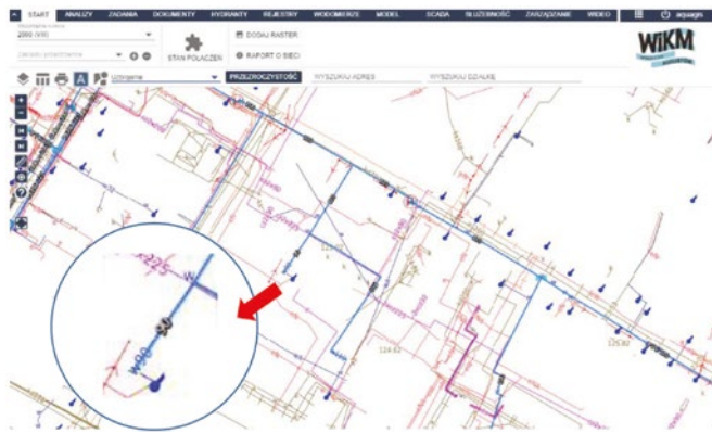
Rys. 6 Przykład wizualizacji danych o wodociągu zebranych w systemie GIS Fig. 6 Example of visualization of data about the water network collected in the GIS system
