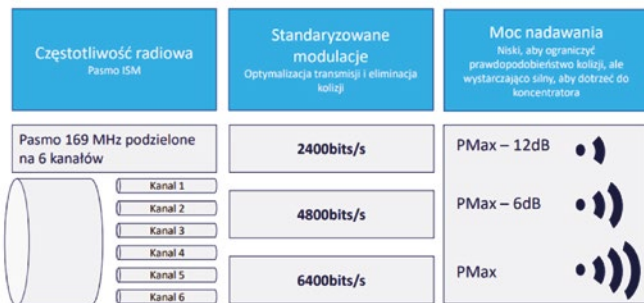
Rys. 1. WIZE 169 MHz – zoptymalizowana częstotliwość, modulacja i moc [13] Fig. 1. WIZE 169 MHz - optimized frequency, modulation and power [13]
