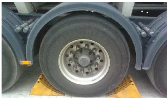
Rys. 10. Zabezpieczenie pojazdu (źródło: zdjęcia własne) Fig. 10. LNG road tanker security (source: own picture)
