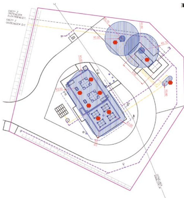
Rys. 5. Przykład stref zagrożenia wybuchem (źródło: projekt stacji LNG) Fig. 5. Example of explosion hazard zone (source: project of LNG station)
