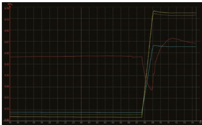
Rys. 18. Zmiany ciśnienia i poziomu napełnienia LNG w zbiorniku (źródło: PSG, pomiary z telemetrii) Fig. 18. Pressure changes and LNG level in cryogenic vessel (source: PSG, telemetry)
