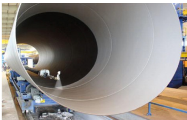
Rys. 3 Malowanie powierzchni wewnętrznej rury
