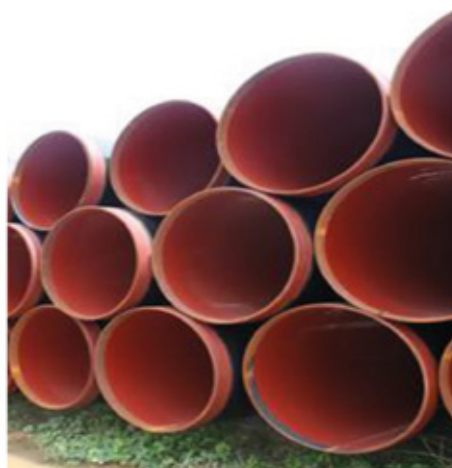
Rys. 4. Składowanie osuszonych rur z powłoką
