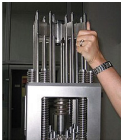
Rys.11. Zespół pręta sterującego do reaktora PWR, nad elementem paliwowym [14]
