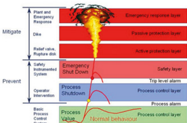
Rys. 6. Wielopoziomowy system zabezpieczeń[17] Fig.6.Multilevel safety system [17]
